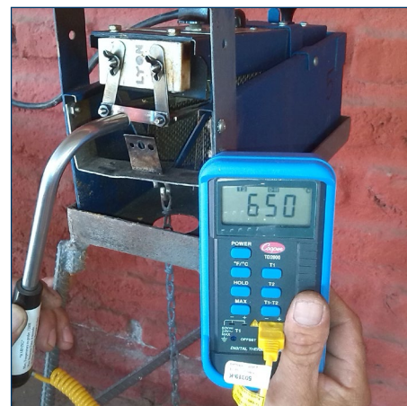
Nhiệt kế chỉ nhiệt độ thích hợp của lưỡi cắt là 650°C.
